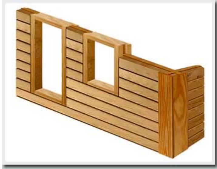
La méthode d'installation des caissons pour la menuiserie.
